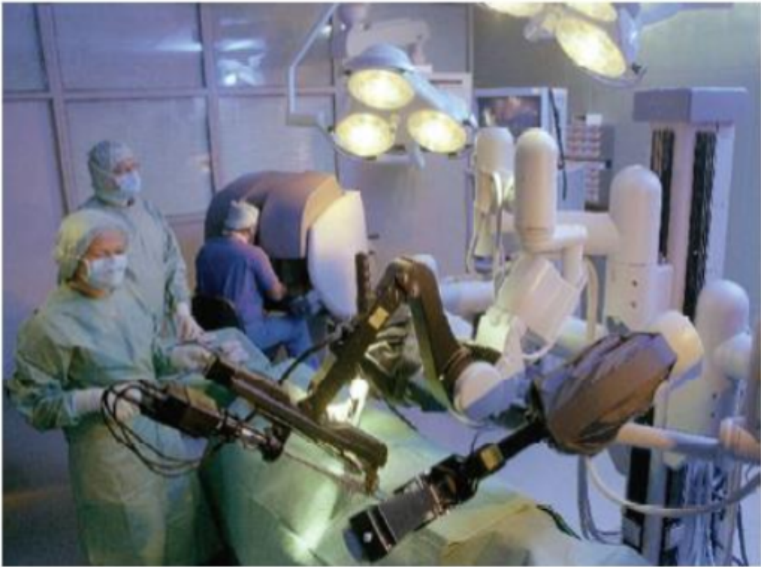
FIGURE 1.6: Exemple d'un robot à centre de rotation déporté contraint par la commande : le robot Da Vinci [Intuitive, 2019]
