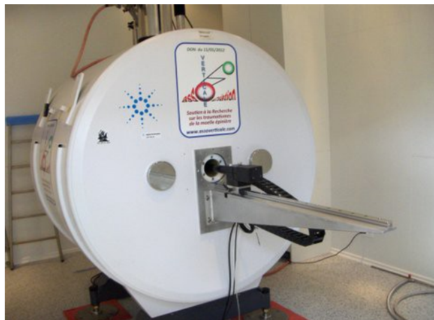
Figure 31: IRM 9.4 Tesla de la plateforme BNIF. Le champ magnétique de l'IRM 9.4T est environ 200 000 fois supérieur au champ magnétique terrestre.
