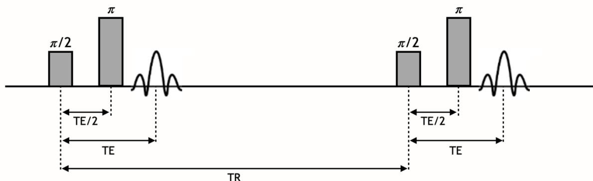
Figure 79: La séquence d'écho de spin est définie par deux paramètres de séquence : le temps de répétition (TR) qui sépare deux impulsions à 90^\circ successives, et le temps d'écho (TE) qui sépare l'excitation de la mesure de l'écho.
