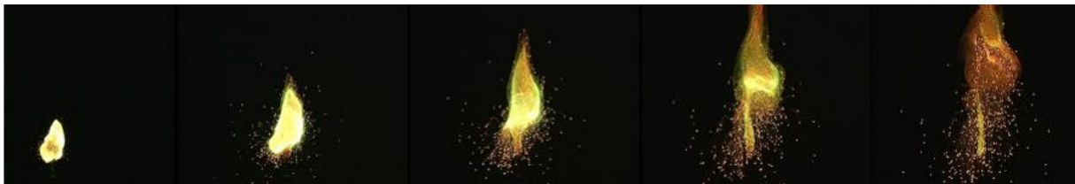
Figure II.6. Explosion de \text{Li}_6\text{B}_{18}(\text{Li}_2\text{O})_1 chauffé à 240 °C. La flamme verte est caractéristique de la combustion d'espèces contenant du bore.
