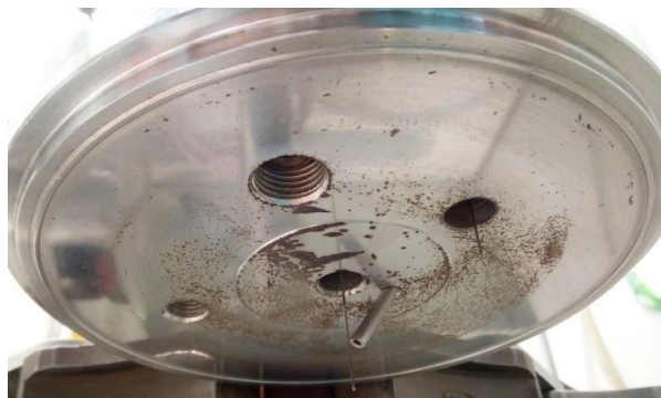
Figure I.27. Couvercle du réacteur après chauffage d'un propergol contenant du perchlorate d'ammonium.
