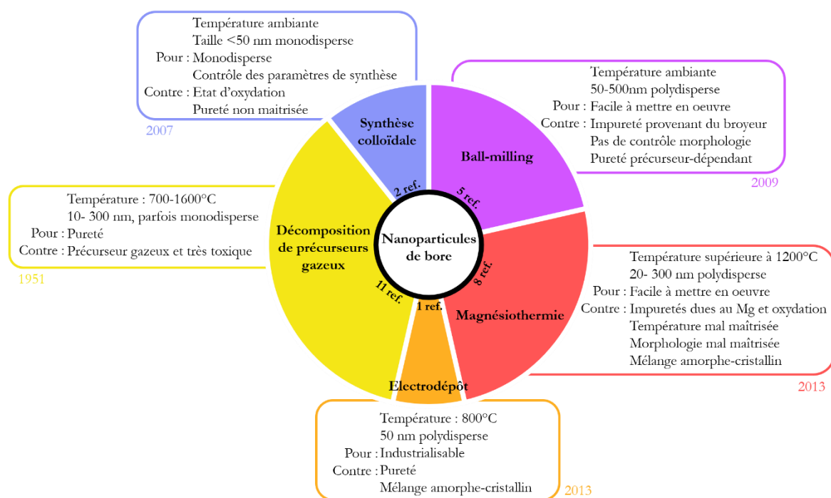
Figure 18. Différentes voies de synthèses menant à des nanoparticules de bore.
