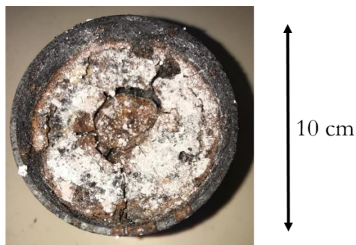
Figure I.13. Bloc de sel obtenu après une synthèse réalisée dans 600 grammes d'iodure de sodium.
