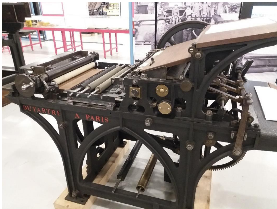
Figure 12 : Presse Dutartre (1865) exposée au musée de l'imprimerie de Malesherbes. Machine présentée à l'exposition universelle de 1867 avec grand succès. Elle imprimait 700 feuilles à l'heure d'un seul côté (photographie prise en 2019)
