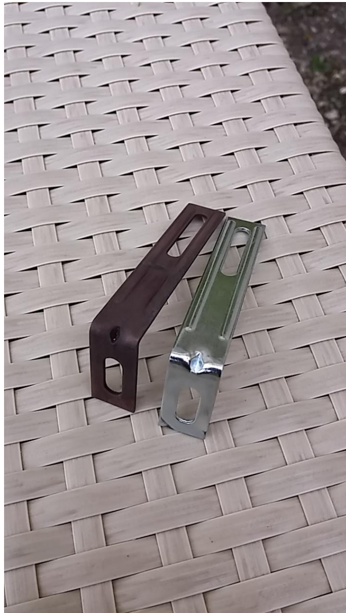
Expérience de galvanoplastie (2018) La pièce de gauche était identique à la pièce de droite (argentée). Après passage au bain, elle est désormais cuivrée.
