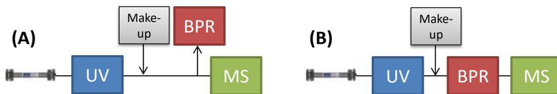
Figure 19 : Configurations des interfaces SFC/MS commerciales
