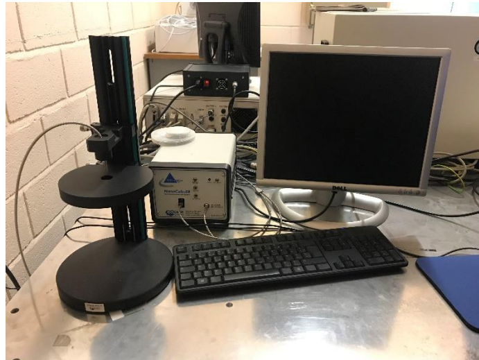
Figure II. 19 : Système utilisé pour la caractérisation par réflectométrie UV-visible
