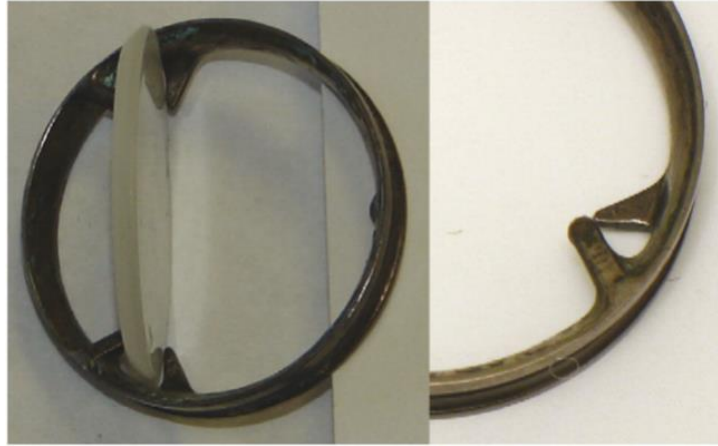
Figure III. 19 : Photographie d'une valve de cœur artificiel en Ti6Al4V revêtue de films de DNC déposé par RF PACVD[152].
