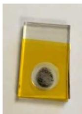
**Figure 6.** Dépôt de  $r\text{-Fe@FeOx}$  NPs sur une électrode FTO pour tester son activité catalytique en oxydation de l'eau à pH 7 et pH 13.
