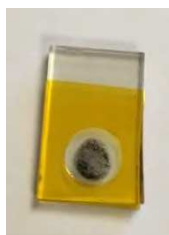
Figure 6. Dépôt de r -Fe@FeOx NPs sur une électrode FTO pour tester son activité catalytique en oxydation de l'eau à pH 7 et pH 13.
