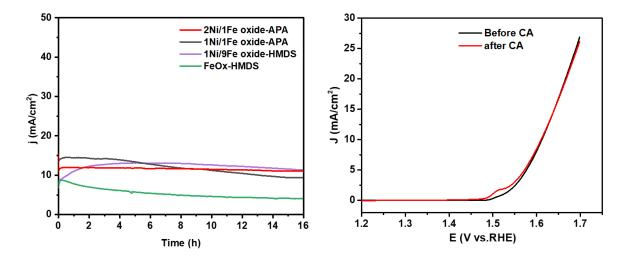
**Figure 12.** a) Évaluation de l'AC de 2Ni/1Fe oxide-APA NPs (ligne rouge), 1Ni/1Fe oxide-APA NPs (ligne noire), 1Ni/9Fe oxide-HMDS NPs (ligne violette), et FeOx-HMDS NPs (ligne verte) à j=10 mA/cm² dans KOH 1M; b) Courbes LSV de l'échantillon 2Ni/1Fe oxyde-APA NPs avant et après l'essai AC.
