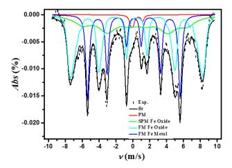
**Figure 2.** Spectre Mössbauer de r-Fe@FeOx NPs enregistré à 80K (données expérimentales en diamants), et meilleur ajustement obtenu (ligne continue) à partir d'une combinaison des contributions du fer et de l'oxyde de fer (voir la légende de la figure)
