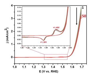
*Figure 13.* Voltamogrammes cycliques (CVs) pour les NiOx-PVP NPs dans un électrolyte KOH 1M. Flèche noire soulignant la diminution de l'activité catalytique lors de balayages consécutifs.
