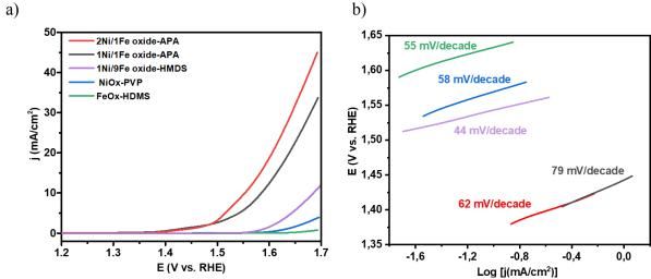
Figure 11. a) Courbes LSV et b) tracés de Tafel correspondants pour 2Ni/IFe oxyde-APA NPs (ligne rouge), 1Ni/IFe oxyde-APA NPs (ligne noire), 1Ni/9Fe oxyde-HMDS NPs (ligne violette), NiOx-PVP NPs (ligne bleue) et FeOx-HMDS NPs (ligne verte) dans KOH 1M, vitesse de balayage 5mV/s.
