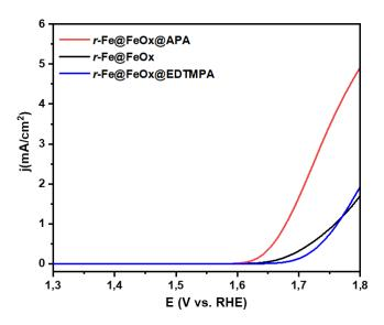
**Figure 8.** Courbes de polarisation des électrodes r-Fe@FeOx NPs (trace noire), r-Fe@FeOx@APA NPs (trace rouge) et r-Fe@FeOx@EDTMPA NPs (trace bleue) enregistrées dans des solutions électrolytiques de pH 13, à une vitesse de balayage du potentiel de 5 mV/s.
