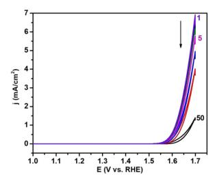
Figure 14. Superposition de 50 voltamogrammes cycliques (CV) pour des NPs FeOx-HMDS dans un électrolyte KOH 1M. Flèche noire soulignant la diminution de l'activité catalytique lors de balayages successifs.
