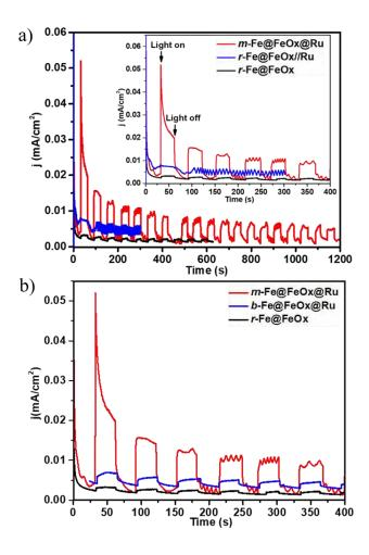
Figure 9. (a) Courbes I-t enregistrées sur des photoanodes m-Fe@FeOx@Ru NPs (trace rouge), r-Fe@FeOx//Ru (trace bleue) et r-Fe@FeOx NPs (trace noire); (b) Courbes I-t enregistrées sur des photoanodes m-Fe@FeOx@Ru NPs (trace rouge), b-Fe@FeOx@Ru NPs (trace bleue) et r-Fe@FeOx (trace noire). Potentiel appliqué: 1.0 V/ENH. Electrolyte: solution NaOH à pH 13. Puissance lumineuse incidente: 100 mW/cm².
