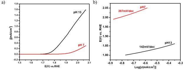
**Figure 7.** a) Courbes de polarisation d'une électrode r-Fe@FeOx NPs enregistrées dans des solutions électrolytiques de pH 7 (ligne rouge) et pH 13 (ligne noire), à une vitesse de balayage du potentiel de 5 mV/s. b) Droites de Tafel de l'électrode r-Fe@FeOx NPs à pH 7 (ligne rouge) et pH 13 (ligne noire).
