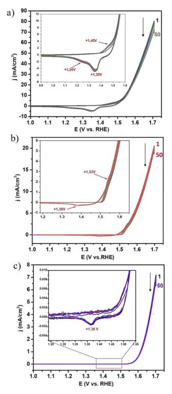
Figure 29. 50 premiers CV de a) 2Ni/1Fe oxide-APA, b) 1Ni/1Fe oxide-APA, c) 1Ni/9Fe oxide-HMDS dans KOH 1M, taux de balayage 5mV/s après activation par LSV.
