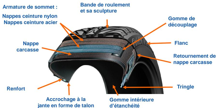
FIG. 2.1 – L'architecture et les composants d'un pneumatique.
