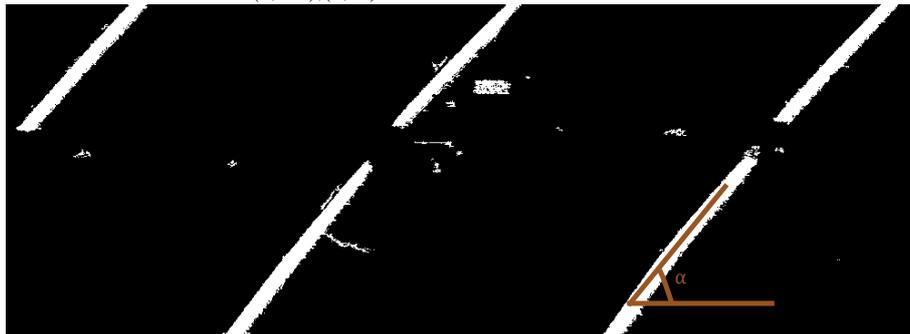
(c) Seuillage par hystérésis  $seg_1 = T_{(1;30)}(f_6)$  et détermination de l'angle  $\alpha$  des stries.
