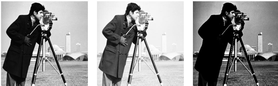
(a) Image initiale  $f$ . (b) Multiplication de  $f$  par un scalaire  $\lambda = 0,1$  :  $\lambda \triangle f$ . (c) Multiplication de  $f$  par un scalaire  $\lambda = 3$  :  $\lambda \triangle f$ .
