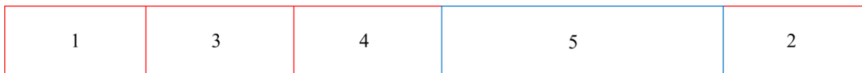
Figure 4-17 : Ordre des passes « linéaire » modélisé, exemple ici d'un ordre Gauche Droite (la dernière passe, n°5, est plus large puisqu'elle ne subit pas de refusion latérale).
