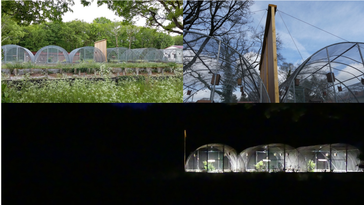
Figure 19. Dispositif expérimental pour l'éclairage nocturne des volières. En haut à gauche : les 3 volières témoins (à gauche) sont isolées des 3 volières éclairées (à droite) par un panneau en bois de 4 m de haut. En haut à droite : le panneau est maintenu en place par des câbles en acier fixés à la structure porteuse en béton des volières. En bas : la nuit, les 3 volières témoins sont dans l'obscurité totale grâce au panneau qui les isole des volières éclairées.
