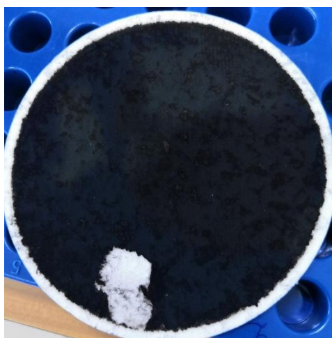
Figure 5.2: Filtre en cellulose contenant des particules CAST propane
