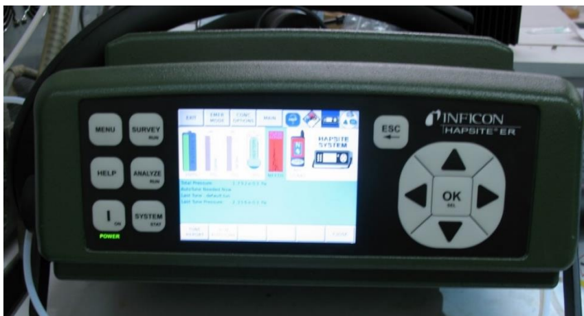
Figure IV-7 : INFICON HAPSITE spectromètre de masse pour l'identification des composés à faible concentration
