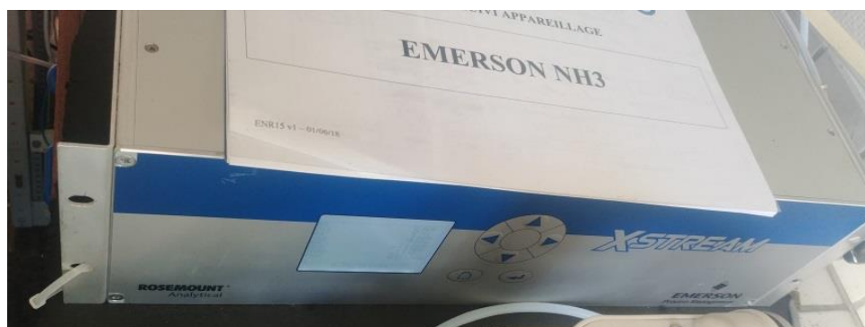
Figure IV-3 : Spectromètre X-STREAM EMERSON pour la quantification des composés azotés
