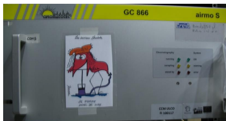
Figure IV-4 : Chromatotec GC 866 Chroma S pour l'identification et la quantification des composés soufrés
