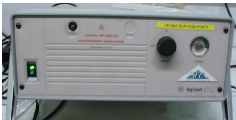
Figure IV-2 : Chromatographie en phase gazeuse pour la quantification du CH 4 et CO 2
