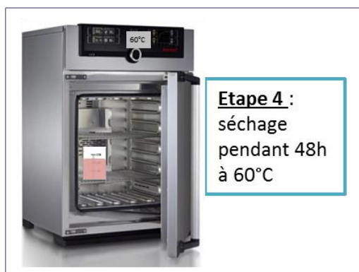
Figure I-40 : Schéma de la synthèse par co-précipitation à partir de nitrates métalliques par voie hydrotalcite
