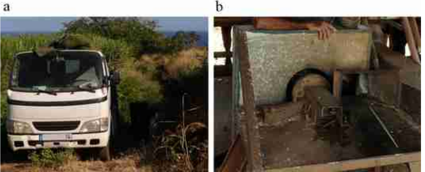
Photographie 7: Matériel utilisé dans les élevages engraisseurs traditionnels : pick-up pour l'affouragement en vert (a) et broyeuse péi pour le broyage de la canne à sucre fraîche (b)
