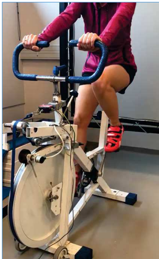
Sujet installé sur la bicyclette instrumentée pour l'épreuve force-vitesse
