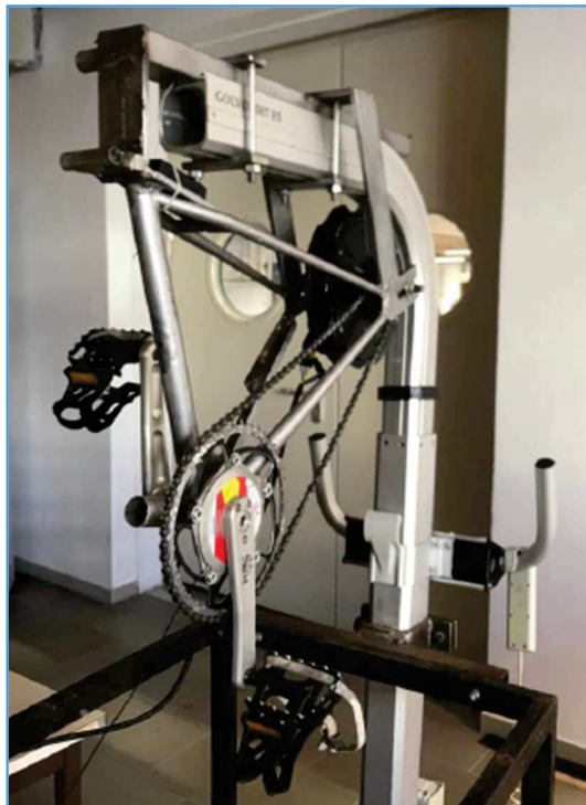
Montage initial de l'ergomètre excentrique
