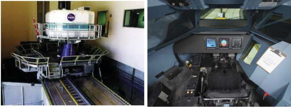
FIGURE 5.1 – Vertical Motion Simulator. (Gauche) VMS vu de l'extérieur. (Droite) Intérieur de la cabine
