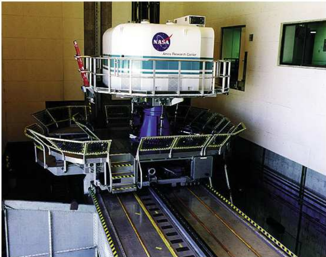
FIGURE 2.7 – Exemple de simulateur à base mobile : Le Vertical Motion Simulator du centre de recherches Ames de la NASA
