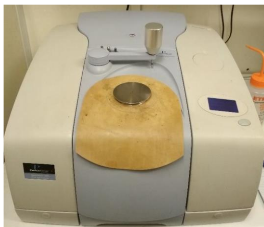
Figure T-3 : Spectroscopie FTIR avec un module ATR-diamant
