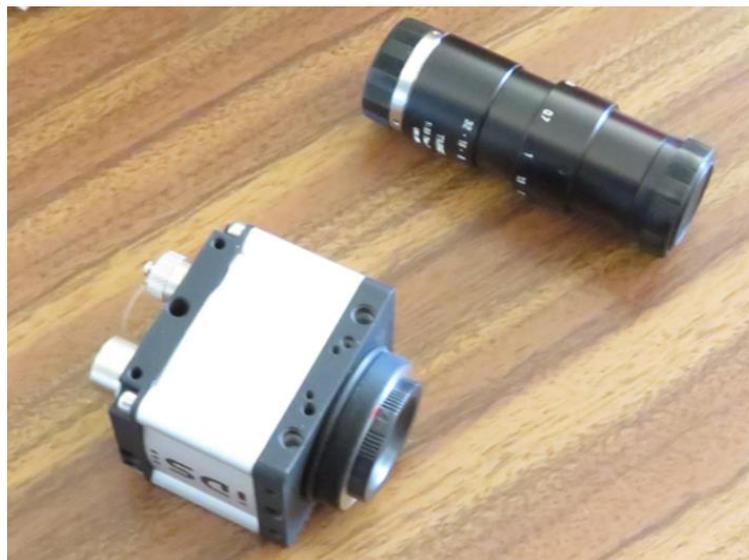
FIGURE I-30 : Issue de [53] : Caméra utilisée pour les mesures de rétro-visée, avec l'objectif.
