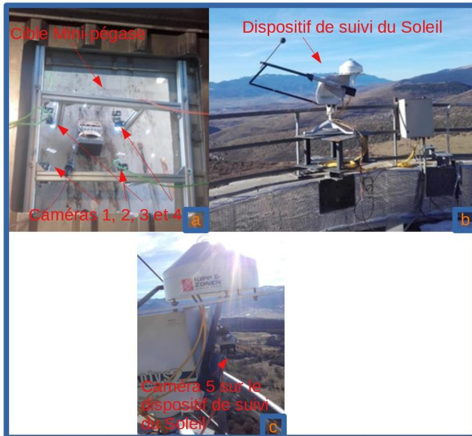
FIGURE III-5 : (En a) Photographie de la cible Mini-Pégase vue de derrière par l'opérateur, avec les quatre caméras fixées sur l'armature métallique. (En b) Photographie du robot de suivi solaire situé sur le toit de la tour Thémis de Targassonne. (En c) Emplacement de la caméra n°5 sur le robot de suivi solaire pour capturer des séries d'images de l'astre, avant et après les prises d'images de l'héliostat par les quatre caméras.
