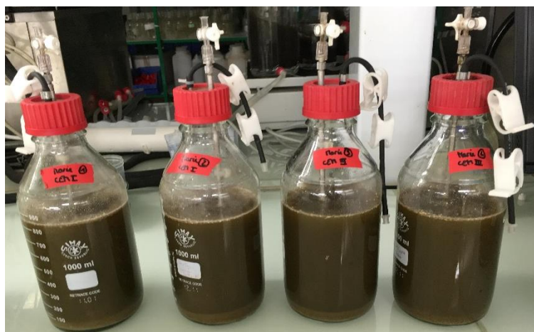
Figure II - 2 : Bioréacteurs utilisés pour les expériences
