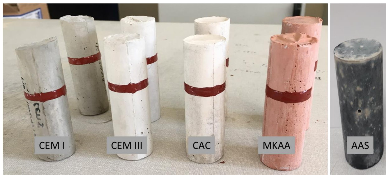
Figure IV - 4 : Échantillons de matériaux avant insertion dans la brisure de maïs en digestion – de gauche à droite : pâtes de CEM I, CEM III, CAC, MKAA et AAS
