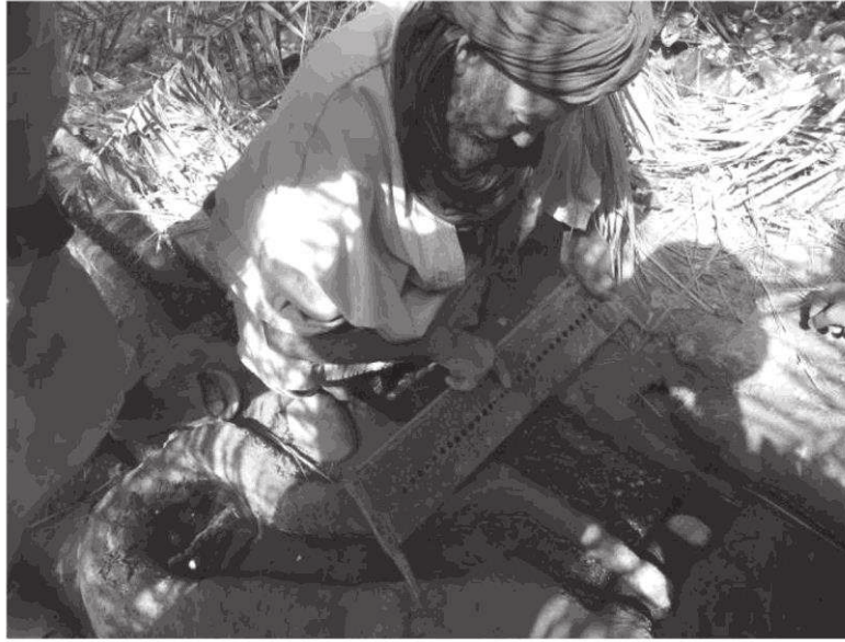
Figure I. 5 : Un kial (mesureur de débit) utilise une chekfa en cuivre pour mesurer le débit de la foggara de Zouiat Lahchef, commune de Reggane
