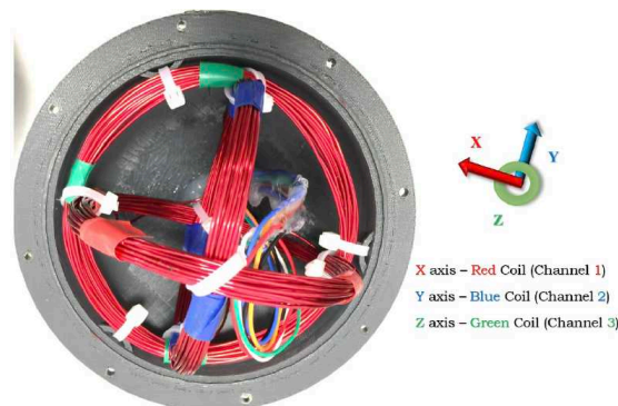
Figure 2-16. Transducteur à 3 bobines réparties sur 3 plans orthogonaux [114].
