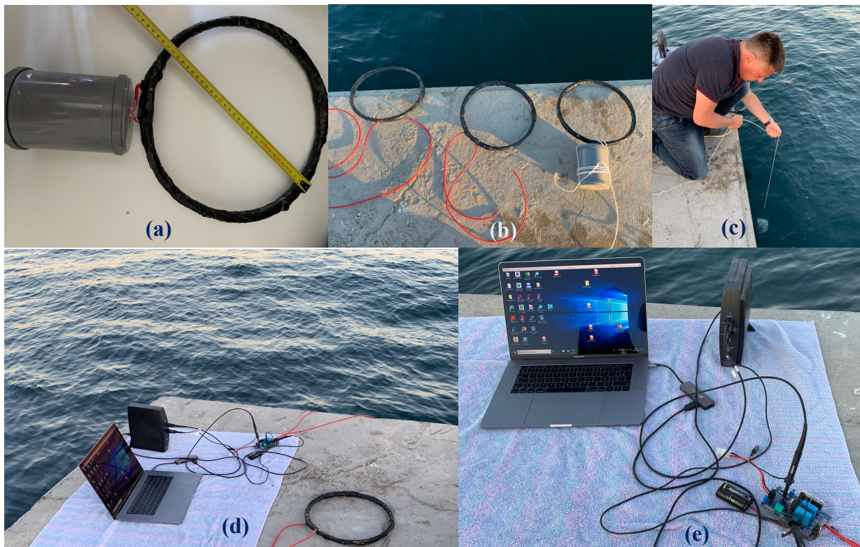
Figure 4-33. Photographie de la configuration expérimentale : du MODEM dans son boîtier(a), des antennes de réception et du modem sur site(b), immersion du MODEM (c), dispositif de mesure connecté à son antenne réceptrice immergée (d), positionnement des sondes sur le MODEM utilisé en réception (e).
