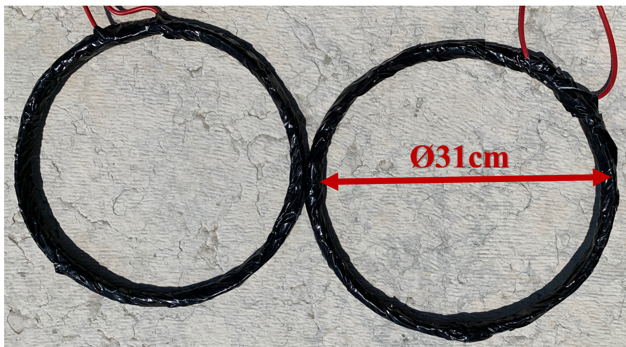
Figure 4-7. Prototypes des antennes boucles de transmission par magnéto-induction à 65kHz (cf. Tableau 4.2).
