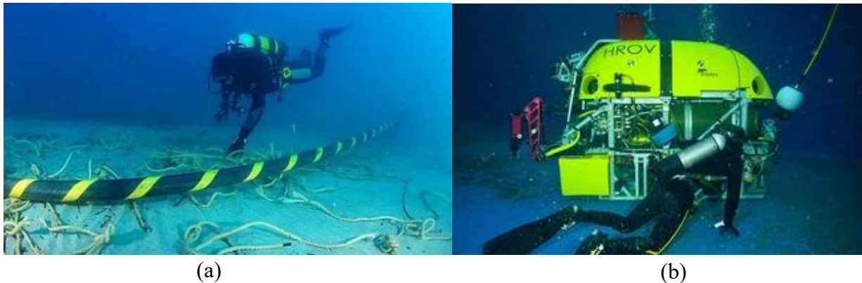
Figure 1-1. Liaisons filaires sous-marines : Câble sous-marin de télécommunication à fibres optiques (a), Drone sous-marin filoguidé (HROV - IFREMER) (b)
