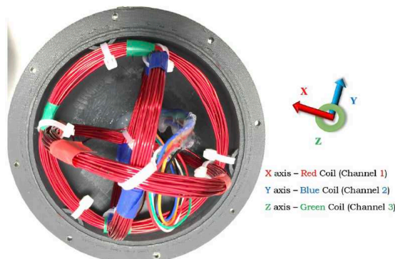
Figure 2-16. Transducteur à 3 bobines réparties sur 3 plans orthogonaux [114].
