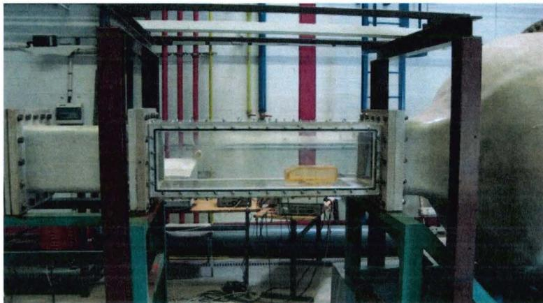
Figure 2.1 – Veine d'essai du canal hydrodynamique polarographique avec maquette.
