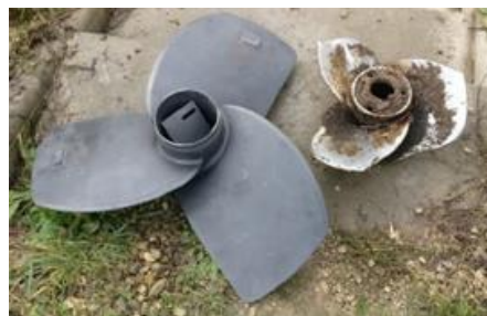
Figure 1-12 Usure des systèmes d'agitation (Photo : S. Pascaud – ENSAIA – Nancy)
