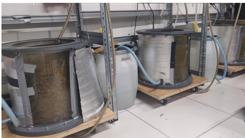
Figure 2-2 60 L batch reactors avec recirculation de phase liquide
