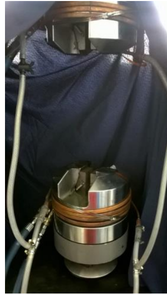
Figure 94 : Système de refroidissement des mors
