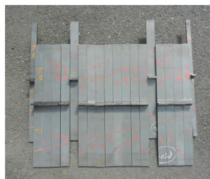
Figure 75 : Tronçonnage des plaques raidies et mise à l'écart des extrémités et tronçons avec interruption du cordon
