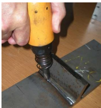
Figure 183 : Illustration du procédé de martelage [Haagensen & Maddox 2010]
