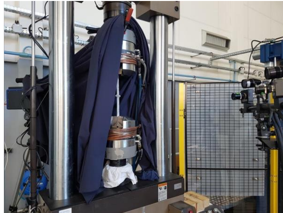
Figure 127 : Mise en place des équipements pour la réalisation d'un essai sur-instrumenté (de g. à d. : caméra IR, machine de traction, système GOM)
