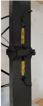
Figure 126 : Face concave de l'éprouvette préparée pour l'acquisition d'images infrarouges
