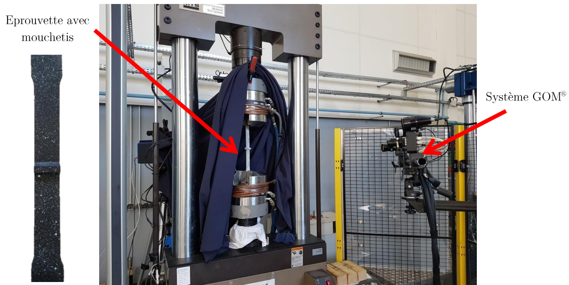
Figure 78: Positionnement du système GOM® de stéréo-corrélation d'images
