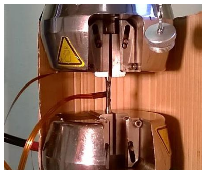
Figure 57 : Photo du montage avec 3 thermocouples
