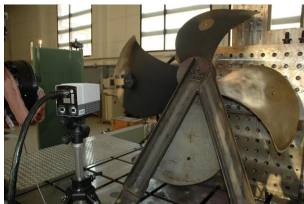
Figure 47 : Montage expérimental permettant la mesure de champs de température sur une pale d'hélice de patrouilleur [Ezanno 2011]
