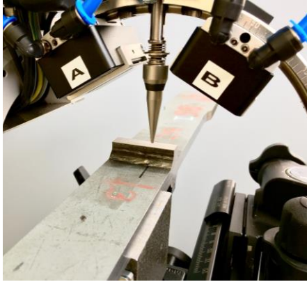
Figure 86 : Montage expérimental permettant l'analyse de contraintes résiduelles par DRX le long d'un profil linéaire tracé en noir
