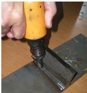
Figure 183 : Illustration du procédé de martelage [Haagensen & Maddox 2010]
