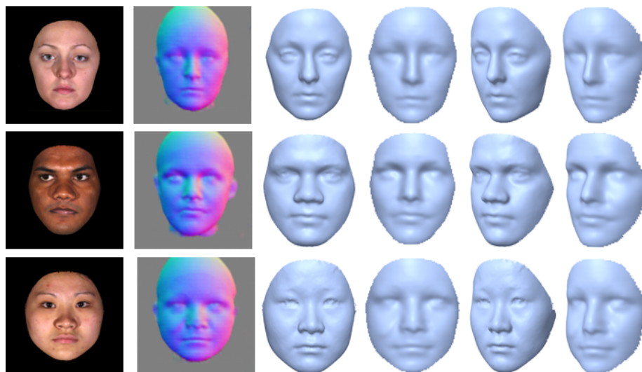
FIGURE 4.9 – Résultats de reconstruction pour trois exemples de BU-3DFE à partir de deux points de vue différents. De gauche à droite : image d'entrée I , carte normale ( \mathcal{N} ), modèle de vérité terrain (vue de face), modèle reconstruit (vue de face), modèle de vérité terrain (vue latérale) et modèle reconstruit (vue latérale).
