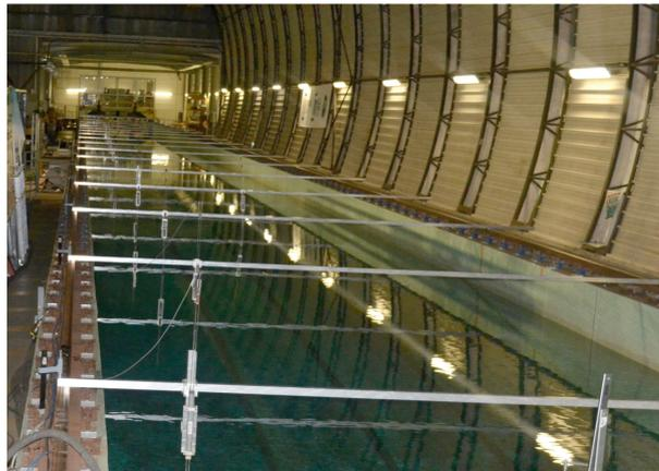
FIGURE 5.1 – Bassin de traction et sondes à houle.
