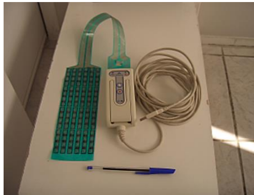
Figure 67 : Capteur utilisé pour la mesure des forces de correction de l'orthèse [29]
