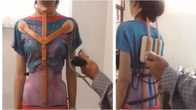
Figure 68 : Mesure de la pression dans les deux côtés de l'orthèse Milwaukee avec un sphygmomanomètre modifié [6]
