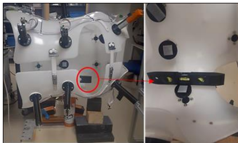
Figure 86 : Calibrage-capteurs : vérification de l'horizontalité des systèmes-capteurs
