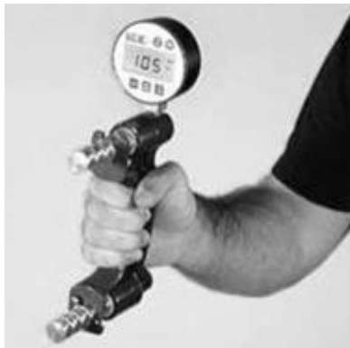
Figure 21 : Manomètre de pression pour mesurer la force de pincement
