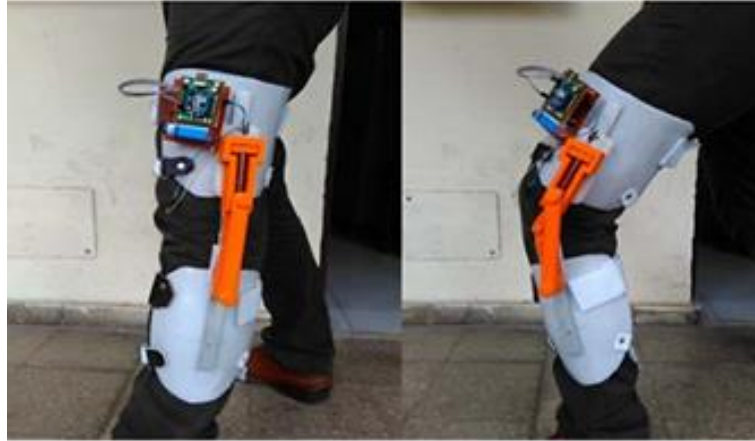
Figure 28 : Système de mesure de l'angle du genou porté sur la jambe
