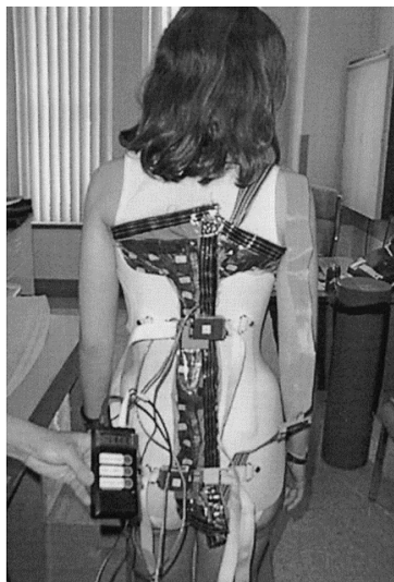
Figure 65 : Essai expérimental de mesure des efforts de correction en fonction de la tension appliquée par la sangle : Sujet portant le tapis de pression sous son corset [53]
