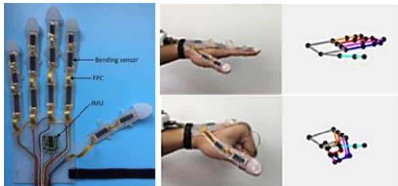
Figure 20 : Gant portable flexible pour déterminer la position de chaque articulation en utilisant des capteurs de courbures
