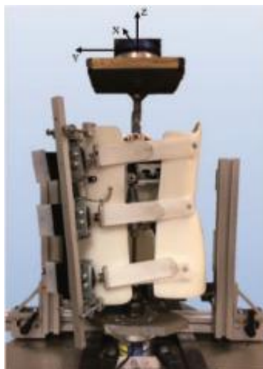
Figure 69 : Modèle analogique de scoliose avec le corset : test expérimental [31]
