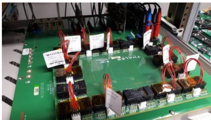
Figure 44 : Photo du banc d'activation dynamique des mémoires NAND
