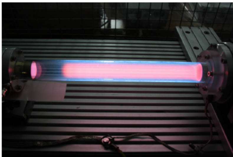
Figure 21 : Photo d'une décharge lumineuse générée sur le banc de test à une pression d'hélium P = 5\text{mbar} pour un courant de 10\text{mA} et une distance inter-électrode de 50\text{cm} .
