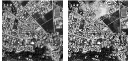
FIGURE 2.6 – Paire d’images acquises par un satellite de Planet Lab, illustrant la difficulté de distinguer les différents objets présents dans la scène. Il est en effet très difficile de distinguer un bâtiment d’un chantier ou d’un terrain en friche, ou encore un champ d’un jardin. L’utilisation d’une méthode « post-classification » semble ici compromise.
