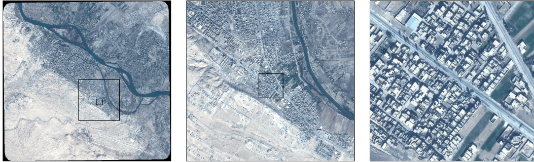
FIGURE 1.4 – Exemple d’images satellites très haute résolution. Il s’agit d’une image prise par le satellite Pléiades-HR 1A, de taille 23082 \times 22080 pixels avec une résolution de 50 cm par pixel. Pour mieux apprécier la taille de cette image, nous avons affiché tout d’abord son intégralité puis deux agrandissements successifs, en représentant l’empreinte de ces derniers par des carrés noirs.
