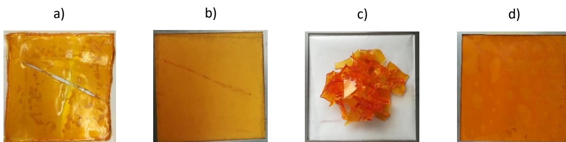
Figure 3 - 6 : a) Échantillon H5-PVIm-20 fissuré et b) même échantillon après avoir été pressé à 40°C, 90 min et à 150 bar ; c) échantillon H5-PMEAA-20 découpé et d) même échantillon après avoir été pressé à 150°C, 90 min et à 150 bar – plaques de dimensions 12 cm x 12 cm x 0,1 cm
