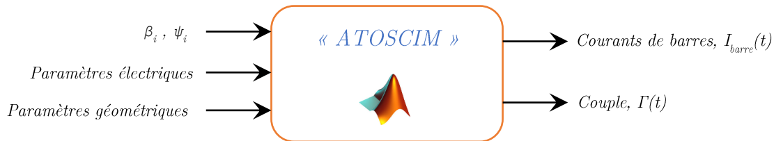
Figure III-12 : Modèle analytique de calcul des performances d'une MAS à cage d'écureuil « ATOSCIM »
