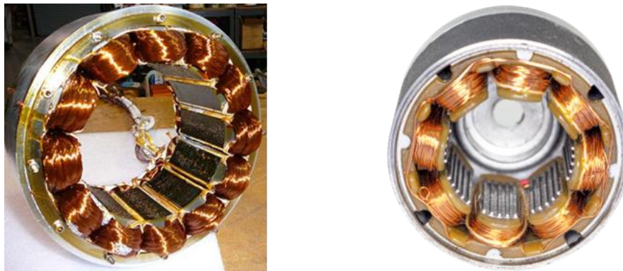
Figure I-3 : Bobinage dentaire double couche [8]
