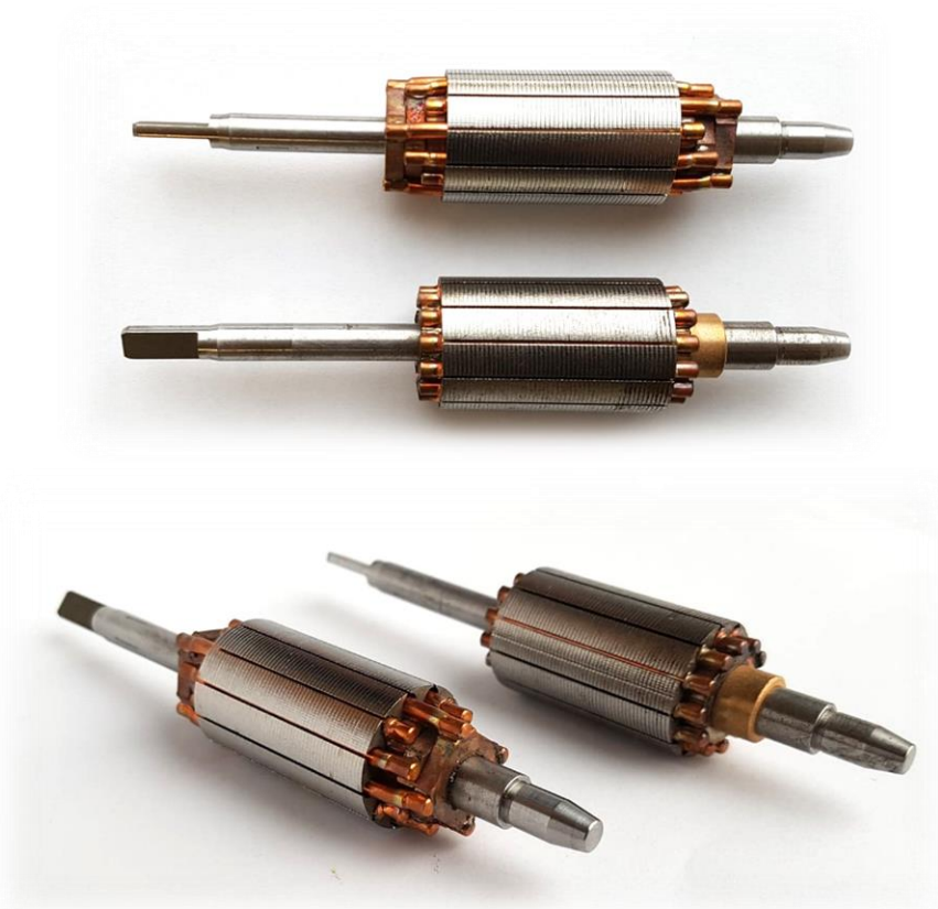
Figure V-32 : Illustration des rotors à 1 et 3 cages
