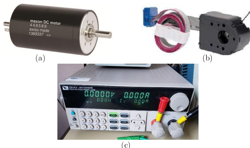
Figure A-5 : Instrumentation du banc d'essai, (a) MCC RE040G, (b) codeur HEDL, (c) charge électronique IT8513C
