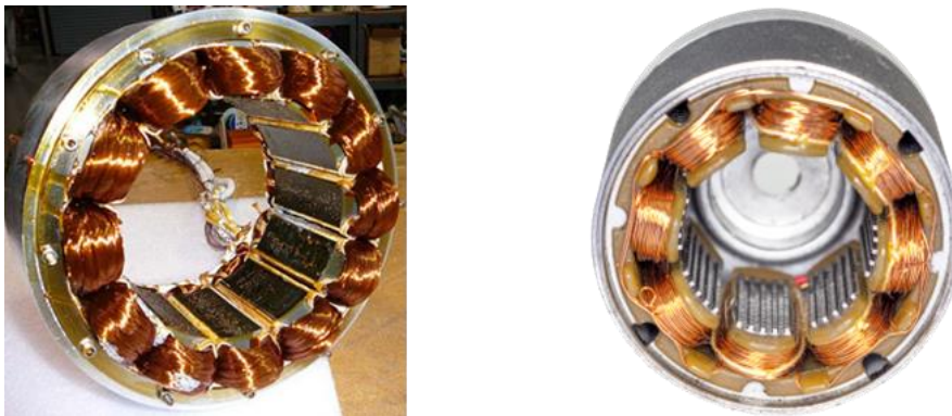
Figure I-3 : Bobinage dentaire double couche [8]
