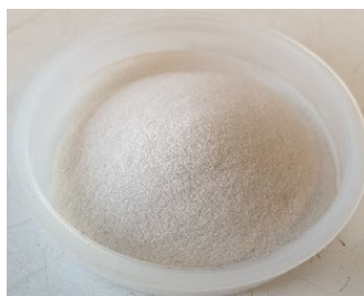
Figure 4.7 Les fines de sable pour colmater les fractures. ( D < 75\mu\text{m} )
