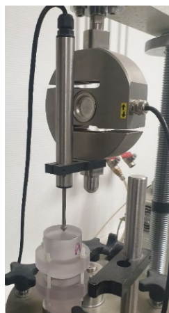
Figure 4.9 Mesure de l'ouverture de la fissure par différence de hauteur de l'échantillon.
