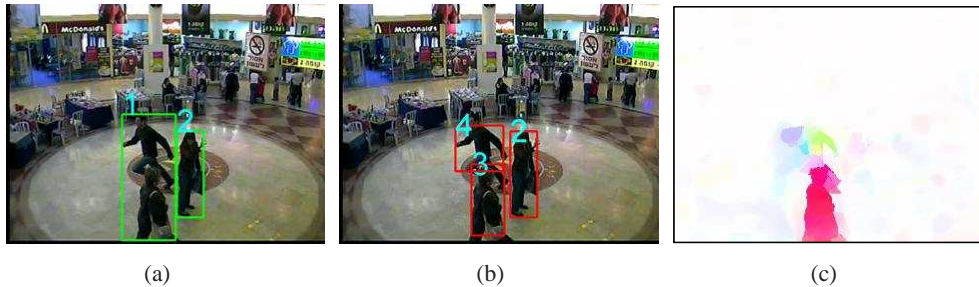
Figure A.4: Les blobs avant et après la méthode d'extraction proposé. (a) 2 blobs extraits sur la base du gabarit de premier plan. (b) 3 blobs extraits par la méthode d'extraction de blob proposé, qui est basé sur le modèle de premier plan et du flux optique. (c) L'image du flux optique de la Fig.(a)(b).
