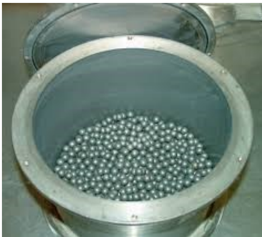
(a) Charge abrasive pour essai Micro Deval
