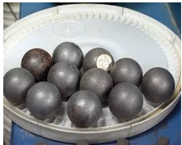
(b) Charge abrasive pour Essai Los Angeles
