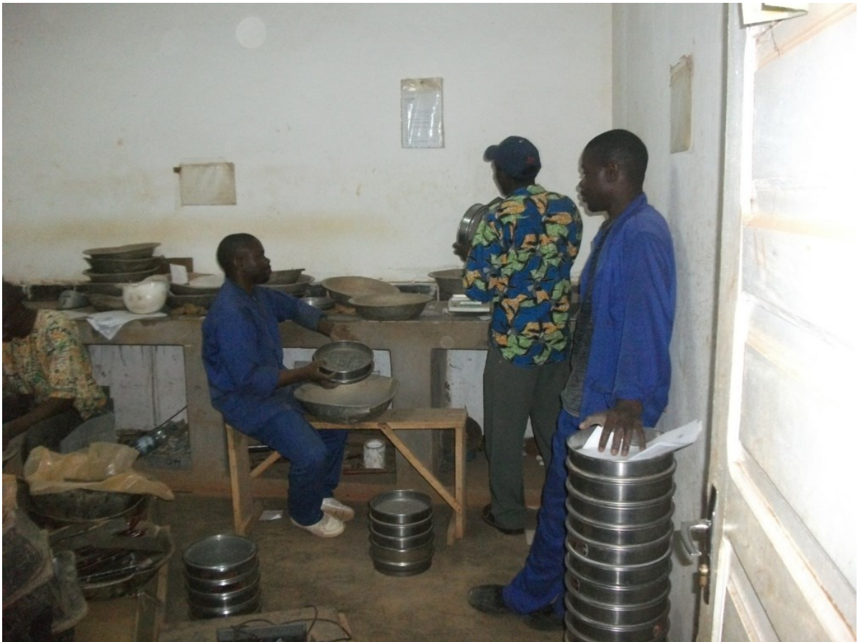
Figure 11. Sélection des tamis et tamisage des granulats
