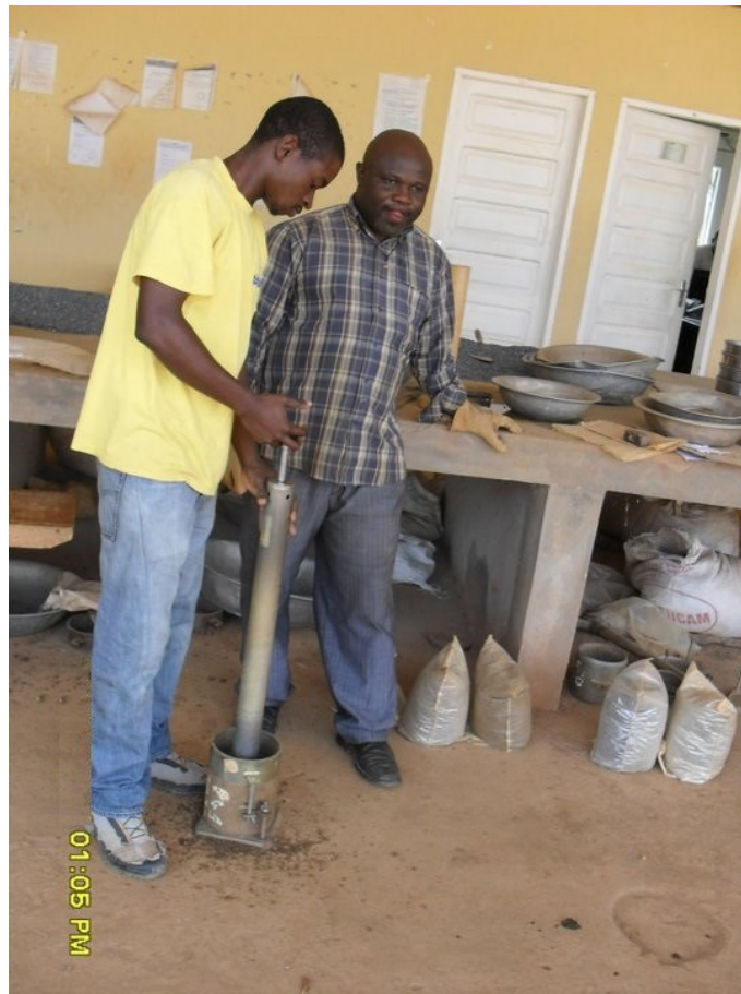
Figure 15. Réalisation de l'essai Proctor
