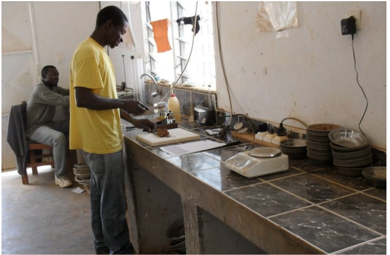
Figure 14. Réalisation de l'essai de détermination des limites d'Atterberg (limite de plasticité)
