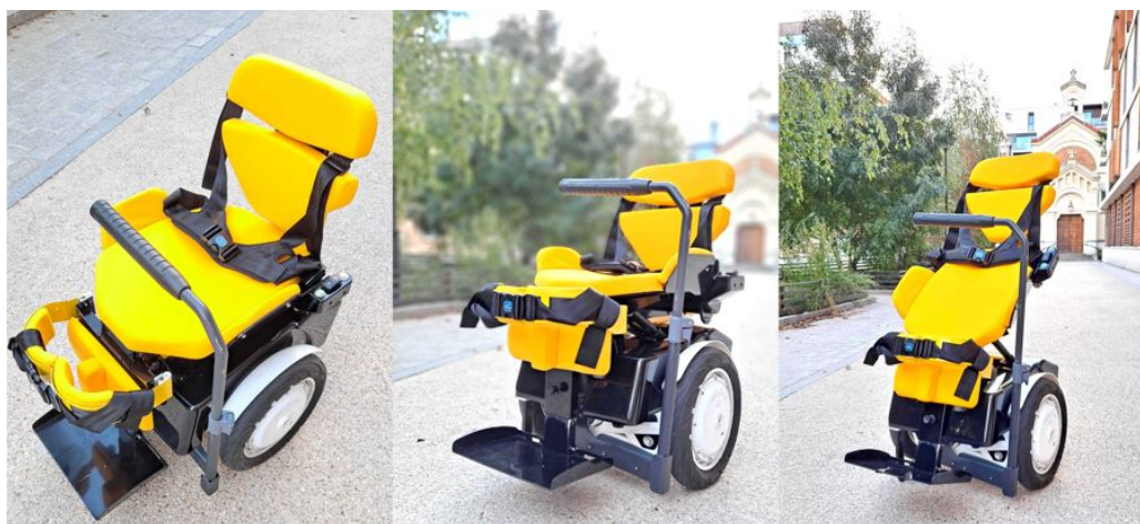
FIGURE 7.1 – Prototype pré-industriel du Gyrolift
