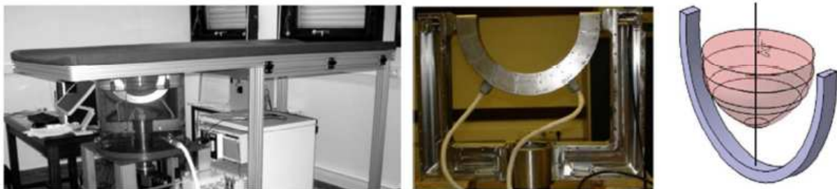
Figure I.6 : Schéma d'ensemble du système ANAÏS et son antenne demi-circulaire.
