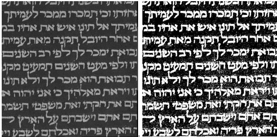
Figure II.12 : Exemple montrant les limites du seuillage par l'algorithmme d'Otsu.
