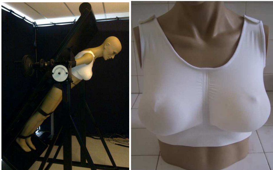
Figure III.30 : Table basculante inclinée à 30° et mannequin
