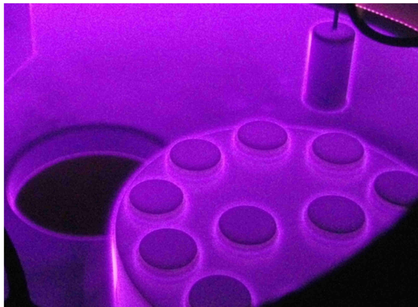
Figure III.7 : Photographie des échantillons en acier inoxydable placés dans le four pour la nitruration plasma (CRITT).
