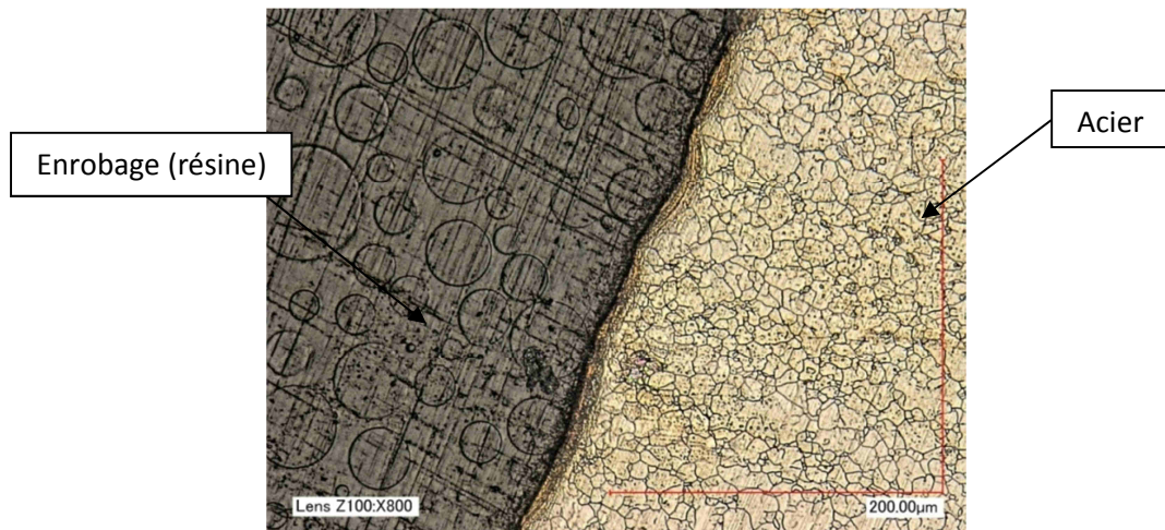
Figure III.2 : Microstructure de l'échantillon traité par SMAT observée au microscope numérique.
