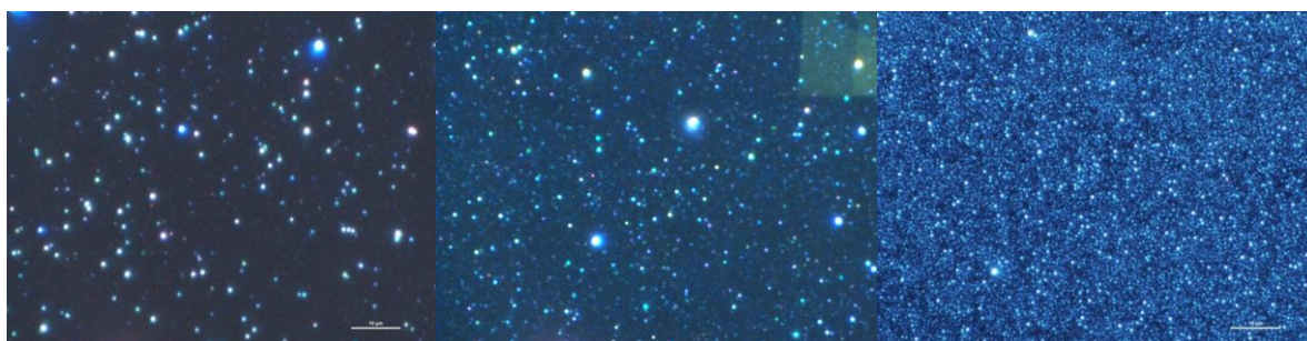
Figure 74 : Images de microscopie optique en mode champ sombre montrant l'évolution de la densité des NPs d'Ag en fonction de la concentration de sel en solution : (a) : 0,0066%, (b) : 0,0165%, (c) : 0,066%.
