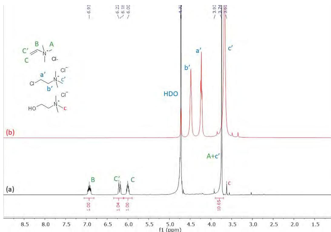
**FIGURE D.56** – Spectre RMN-<sup>1</sup>H à 25 °C dans le D<sub>2</sub>O du DES ClClCh-Urée (1 : 2) en présence de NaOH (5 équivalents molaires) après 15 heures à 90 °C (a) Spectre RMN-<sup>1</sup>H à 70 °C dans le D<sub>2</sub>O du DES ClClCh-Urée (1 : 2) (b).
