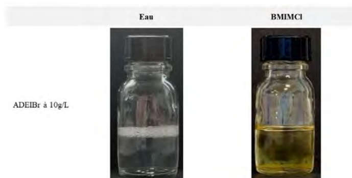
FIGURE B.16 – Photographies de solutions de ADEIBr à 10g/L dans l'eau ou le BMIMCl.
