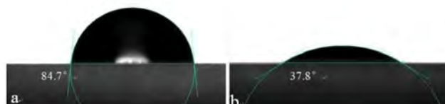
FIGURE I.20 – Mesures d'angle de contact par de l'eau sur un film de décanoate d'amidon (a) et d'amidon (b).
