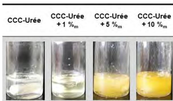
**FIGURE D.49** – Observations macroscopiques à 25 °C de ClClCh-Urée et des mélanges Guar/ClClCh-Urée avec 1, 5 et 10%<sub>m</sub> de guar, à température ambiante (pour le DES, après 1 heure de chauffe ; pour les mélanges, après 15 h à 80 °C).
