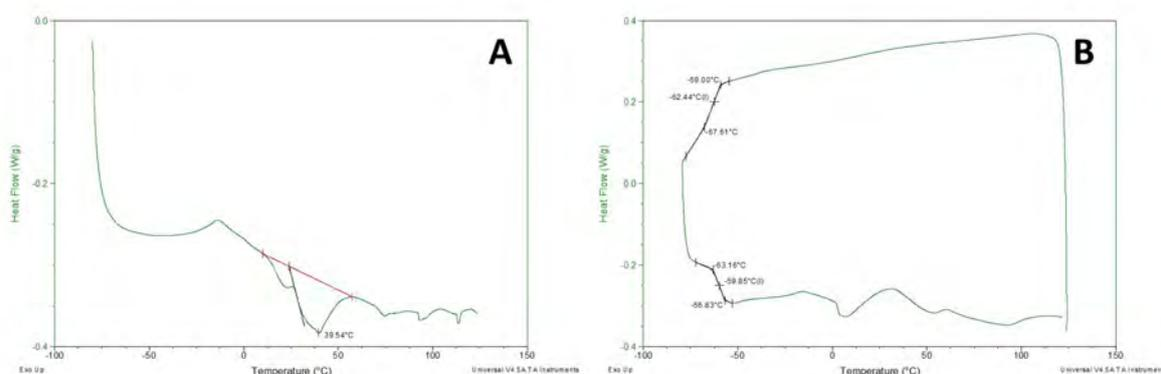
**FIGURE D.46** – Mesure de Calorimétrie Différentielle à Balayage du DES Chlorochlorure de cholinium-Urée (1 : 2) avec **A.** une montée en température (a) de  $10\text{ °C/min}$ , **B.** une descente en température (b) de  $10\text{ °C/min}$  puis une nouvelle montée (c) à  $10\text{ °C/min}$
