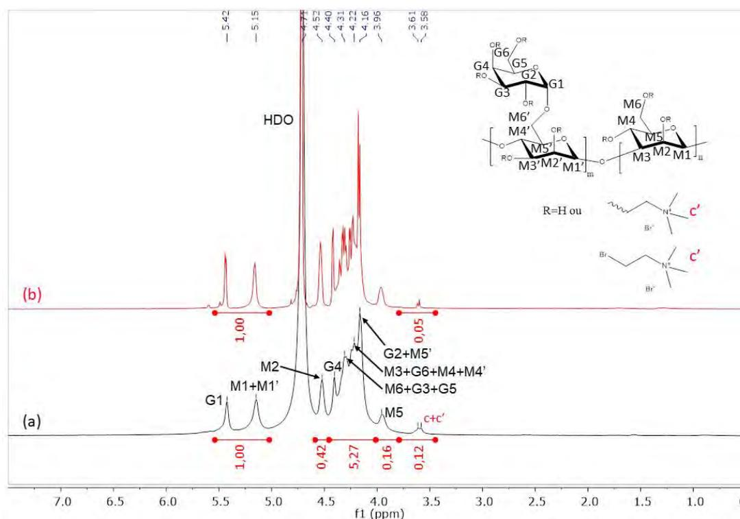
**FIGURE D.62** – Spectre RMN- $^1\text{H}$  à 70 °C dans le  $\text{D}_2\text{O}$  du guar isolé après introduction dans le ClCh-Urée (1 : 2) en présence de NaOH (5 équivalents molaires) après 15 heures à 90 °C (a) Spectre RMN- $^1\text{H}$  du guar récupéré après mélange dans le DES ClCh-urée (1 : 2) (expérience témoin) (b).
