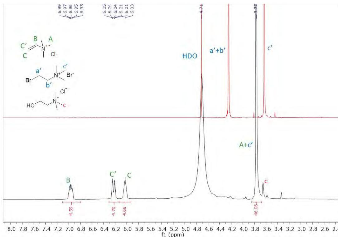
**FIGURE D.63** – Spectre RMN- $^1\text{H}$  à 25 °C dans le  $\text{D}_2\text{O}$  du guar étherifié dans le DES BrBrCh-Urée (1 : 2) en présence de NaOH (5 équivalents molaires) après 15 heures à 90 °C.
