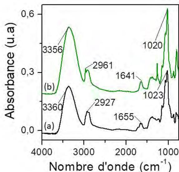
**FIGURE D.59** – Spectre IR du guar isolé après contact avec le ClCICl-Urée (1 : 2) en présence de TBN<sup>+</sup> ; OH<sup>-</sup> (a) ou en présence de NaOH (b)
