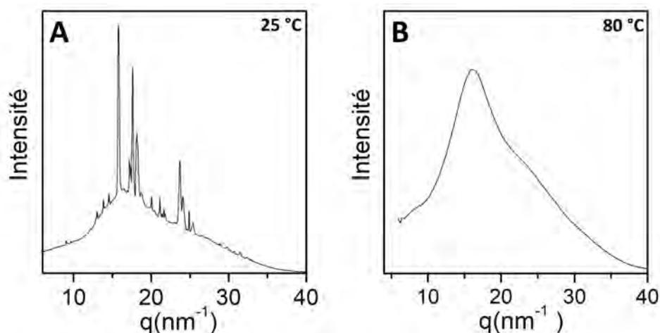
**FIGURE D.48** – **A**) Diffractogramme de Rayons X à grands angles (WAXS) du ClClCh-Urée (1 : 2) fait à 25 °C, après chauffage à 80 °C et refroidissement pendant 30 minutes à 25 °C. **B**) Diffractogramme de Rayons X à grands angles (WAXS) du ClClCh-Urée (1 : 2) fait à 80 °C.
