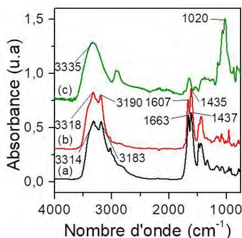
**FIGURE D.51** – Spectre IR en mode ATR du DES ClClCh-Urée (1 : 2) (a), du mélange Guar/ClClCh-Urée à 10 %<sub>m</sub> en guar (b) et du guar (c) à 25 °C.
