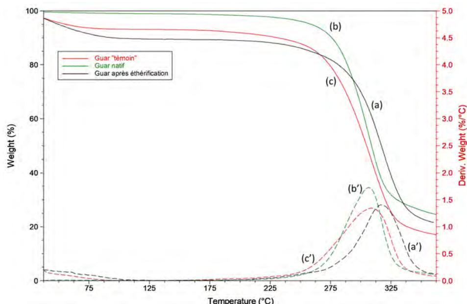
**FIGURE D.55** – Thermogramme du guar isolé après mélange avec ClClCh-Urée (a), du guar natif (b) et du guar “témoin” après purification (c). Les dérivées sont notées respectivement (a’), (b’) et (c’).
