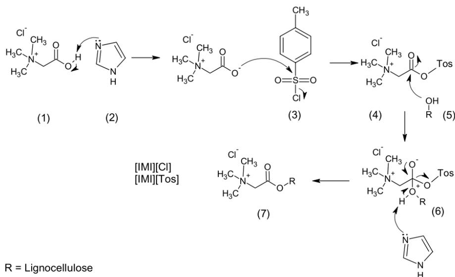
**FIGURE D.44** – Mécanisme de cationisation de lignocellulose (5) par l'utilisation du DES Hydrochlorure de bétaïne (1) - Imidazole (2) avec la participation de tosylate (3) décrite par Sirvio *et al.*<sup>1</sup>
