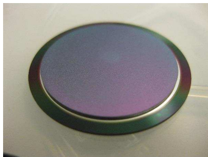
FIGURE 3.18 – Photo d'un assemblage diode PIPS®-électrode diamant par collage par thermo-compression or-or à température ambiante.
