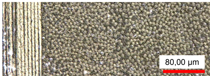
Fig. 4-28. Surface latérale de l'éprouvette de traction pour le stratifié [0_2/90_2]_s
