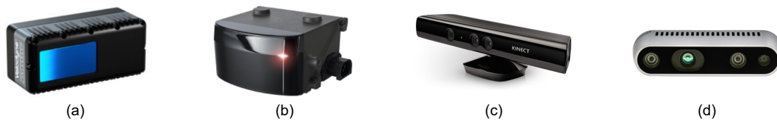
FIGURE 2.20 – Exemples de LiDARs flashs (a,b) et de caméras 3D (c,d,e) : (a) Velodyne Velarray ; (b) Valeo Scala ; (c) Microsoft Kinect ; (d) Intel RealSense.
