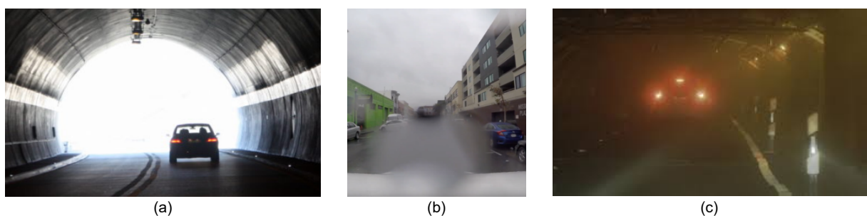
FIGURE 2.6 – Limites de la perception basée vision : Illustrations de phénomènes pouvant affecter la perception basée sur la vision par caméra : (a) Saturation de l'image à cause d'un pic de luminosité ; (b) Présence de gouttes sur l'objectif empêchant la bonne visibilité de la caméra ; (c) Manque de luminosité qui impacte également le bonne visibilité de la caméra. (Images de contexte issues d'internet).
