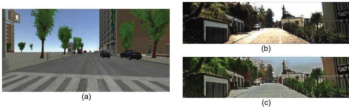
FIGURE 3.8 – Exemple d'application de l'adaptation de domaine : (a) Image de synthèse obtenue par la simulation d'une caméra monoculaire dans un environnement simulé ; (b) Image d'une caméra monoculaire obtenue en conditions d'acquisition réelles ; (c) Exemple d'application de l'adaptation de domaine permettant de rapprocher des données du domaine « monde réel » vers (b) le domaine de la simulation (a). [92].
