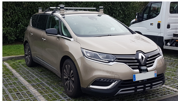
FIGURE 3.19 – MELO : Plateforme du Groupe Renault et utilisée pour les acquisitions en conditions réelles, au sein de l'environnement d'essai EE , correspondant à la carte sémantique 3D.
