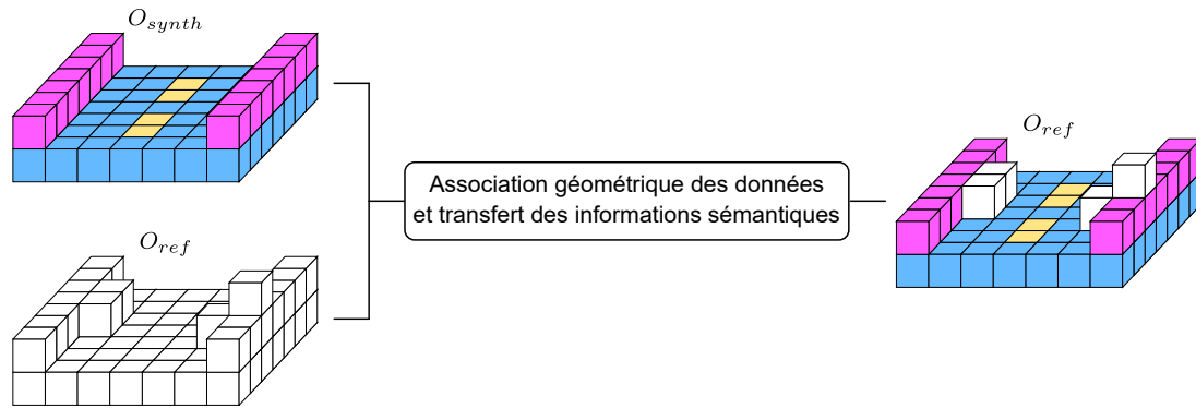
FIGURE 4.23 – Représentation du transfert d'informations sémantiques : Référencement opéré entre les octrees O_{ref} et O_{synth} pour finaliser l'adaptation de domaine et permettre le transfert des informations sémantiques. Les voxels pour lesquels le transfert n'a pas pu être opéré sont représentés en blanc.
